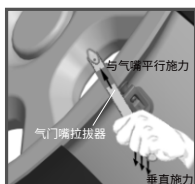
3. 使用气门嘴拉拔器 安装传感器总成
